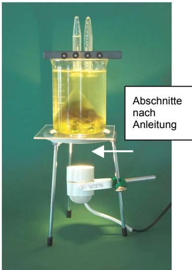
1. Den Versuch, wie aus der Abbildung ersichtlich, aufbauen, danach das Becherglas mit 18 - 20 °C warmem Leitungswasser, welches 2 g NaHCO<sub>3</sub> enthält, bis etwa 2 cm unter den oberen Rand, füllen.
