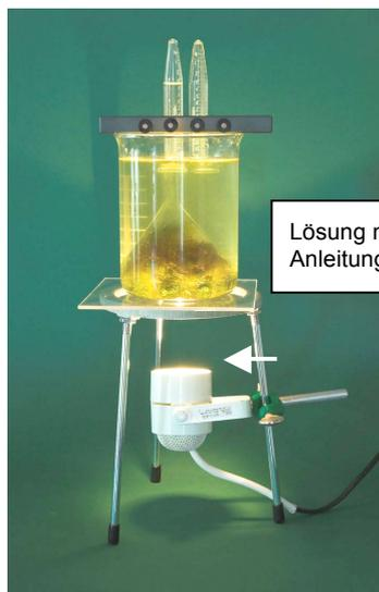
1. Den Versuch, wie aus der Abbildung ersichtlich, aufbauen, danach das Becherglas mit Leitungswasser, welchem 2 g Natriumhydrogencarbonat zur Erhöhung des Kohlenstoffdioxidgehaltes zugegeben worden ist, bis etwa 2 cm unter den oberen Rand, füllen. Das Wasser mit dem  $\text{NaHCO}_3$  sollte eine Temperatur von 18 - 20 °C haben.
