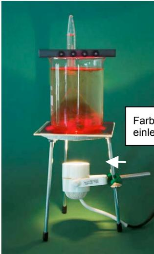
1. Den Versuch, wie aus der Abbildung ersichtlich, aufbauen. Unter das Becherglas einen gelben Farbfilter (ca.600 nm) legen.
