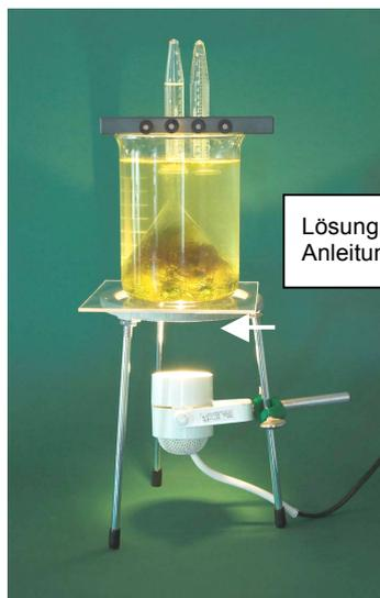
1. Den Versuch, wie aus der Abbildung ersichtlich, aufbauen, danach das Becherglas mit abgekochtem Wasser, bis etwa 2 cm unter den oberen Rand, füllen. Das Wasser sollte eine Temperatur von 18 - 20 °C haben.
