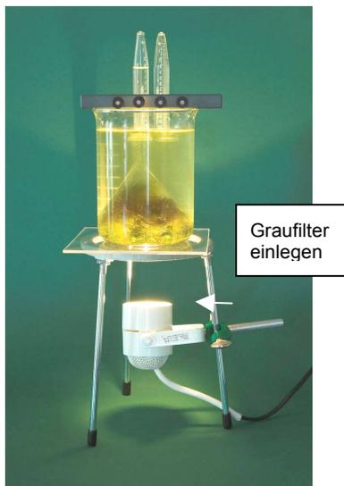
1. Den Versuch, wie aus der Abbildung ersichtlich, aufbauen. Unter das Becherglas zum Abschwächen des Lichtes zwei Graufilter legen.
