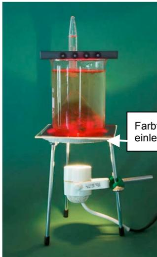
1. Den Versuch, wie aus der Abbildung ersichtlich, aufbauen. Unter das Becherglas einen roten Farbfilter (ca. 665 nm) legen.
