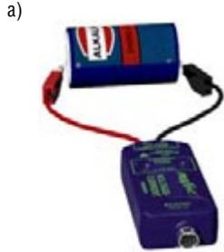
Zur Messung der Spannung an einer Batterie verbinden Sie die Spannungsleiter mit den Batteriepolen.
