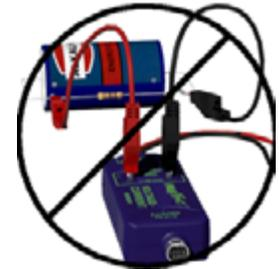
Versuchen Sie nicht, den Strom durch einen Widerstand zu messen, indem Sie die Leiter an beiden Seiten des Widerstands verbinden.
