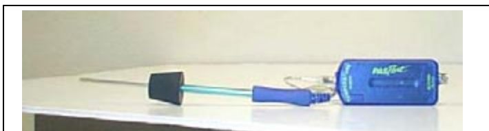
Bild 1: Temperatursonde mit Kunststoffhülle und Stopfen
