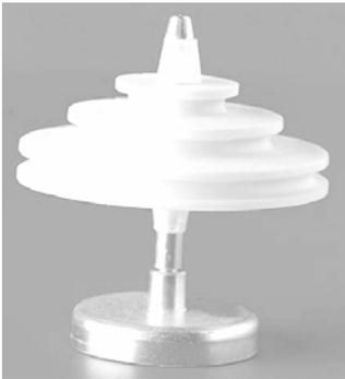
Wellrad mit 3 Führungen (60/40/20 mm Durchmesser), fest auf einer Achse, mit Magnethalter. Jede Führung ist mit einem Loch versehen, um eine Schnur zu befestigen. Einzeln lieferbar unter der Best.-Nr. MT02254.
