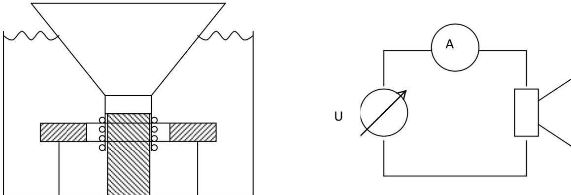
Schließen Sie die variable Spannungsquelle über das Vielfachmessgerät (Strombereich !) an den Lautsprecher an. Drehen Sie die Spannung zunächst auf Minimum (Linksanschlag)
