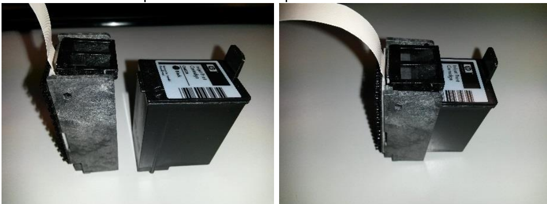
Abbildung 7: Set für Druckspuren des Schwerpunkts zweier gekoppelter Gleiter.
