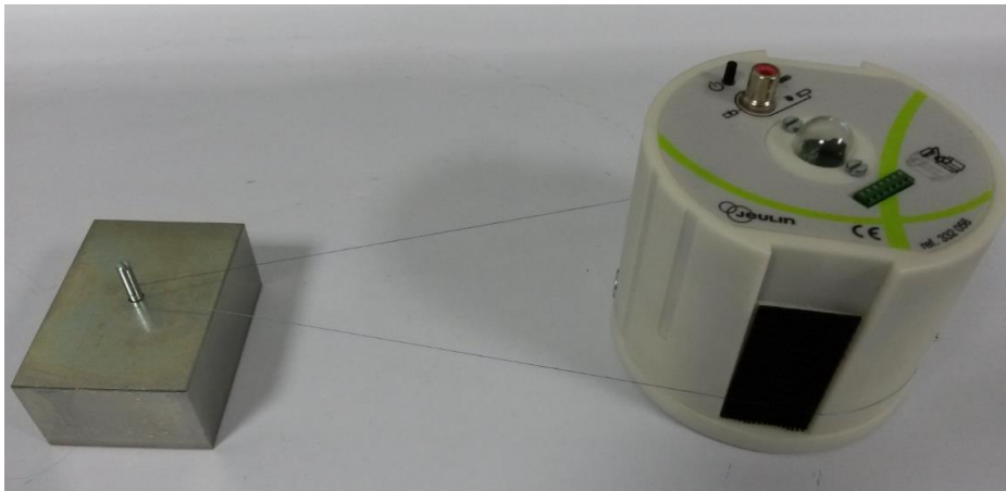
Abbildung 9: An einen Stift angebundener Gleiter zur Beschreibung einer kreisförmigen Bewegung .
