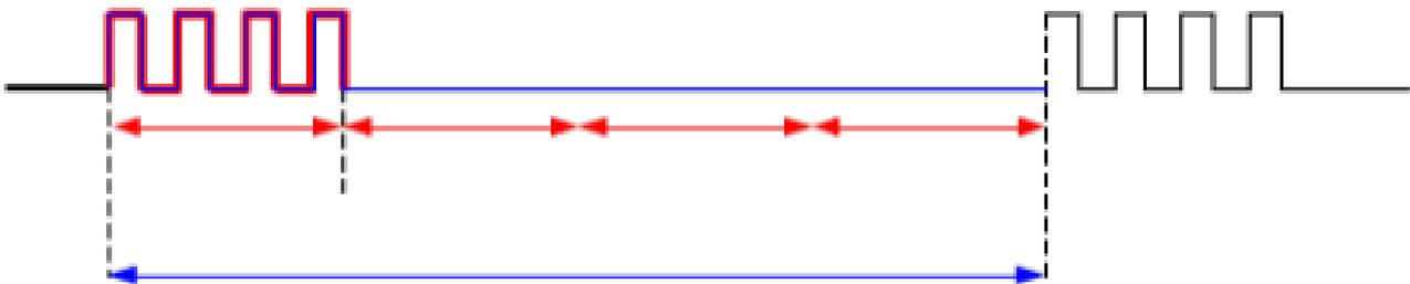
Periode des Burst:  $T_s = 200 \text{ ms}$  (entspr. 5 Hz)
