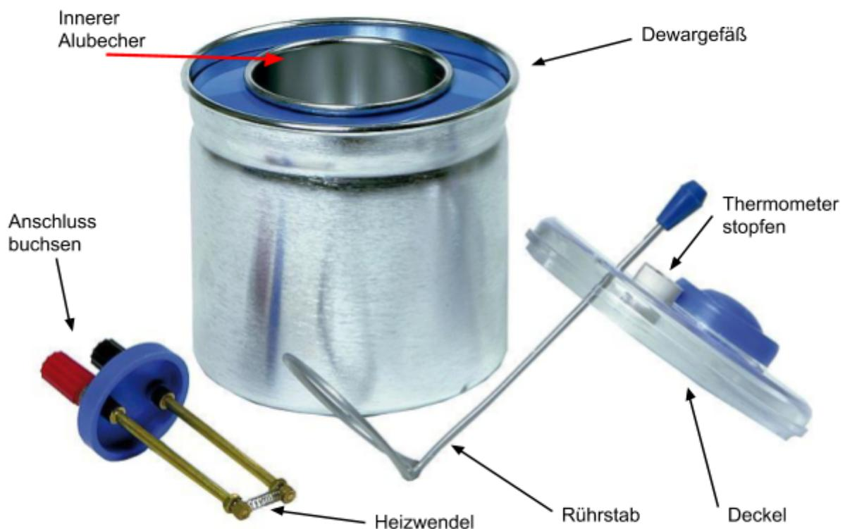
Dieses Kalorimeter besteht aus einem Dewargefäß mit innerem Aluminiumbehälter. Es hat eine transparente Kunststoffabdeckung mit Rührstab, die Öffnungen für ein Thermometers und Heizwendel hat. Das Kalorimeter kommt mit einem Gummistopfen mit einer Bohrung von  $\varnothing 5$  mm für einen Thermosensor oder ein Thermometer. Eine Kappe mit Heizwiderstand mit 4 mm Hülse.
