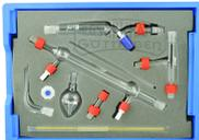
Schülergerät Bausatz Basic mit Sicherheitsverschraubung
