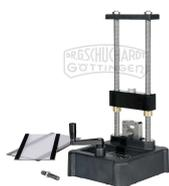
PASCO Gerät zur Messung der Zugfestigkeit von
