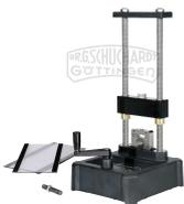
PASCO Gerät zur Messung der Zugfestigkeit von
