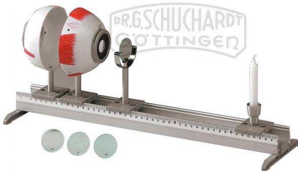
Das Modell dient zur Demonstration der optischen Funktionen des Auges, wie Abbildung eines Gegenstandes auf der Netzhaut, Akkommodation (Veränderung der Linsenkrümmung), Kurz- und Weitsichtigkeit. Das Modell besteht aus einer Augenhalschale mit verstellbarer Irisblende, Linsenhalter sowie 2 Konvexlinsen ( $f = 65 \text{ mm}$  und  $80 \text{ mm}$ ), einer Augenhalschale mit Netzhaut (Transparentschild) sowie je einer Korrekturlinse konkav und konvex, Linsenhalter und Versuchsanleitung.
